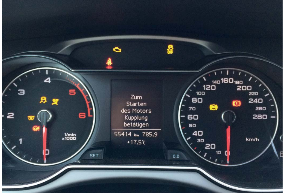
Autodiagnostic avant le démarrage du moteur: les témoins importants s'allument brièvement.
