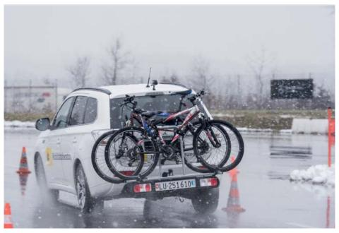
Si le porte-vélos est monté sur le crochet d'attelage, veiller à un serrage suffisant pour éviter qu'il ne bouge en cas de manoeuvre d'évitement.
